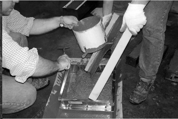
Foto 5: Lavado del hormigón
