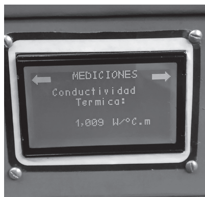
Figura 9. Pantalla del equipo, resultado de conductividad térmica
