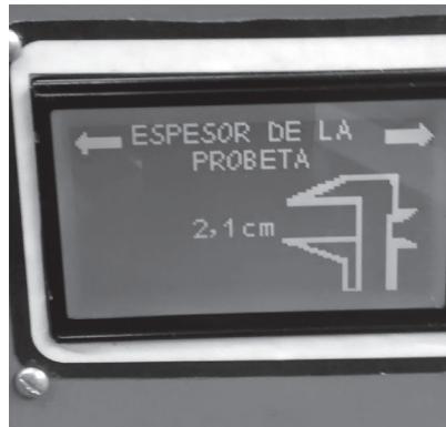
Figura 7. Pantalla del equipo, medición del espesor
