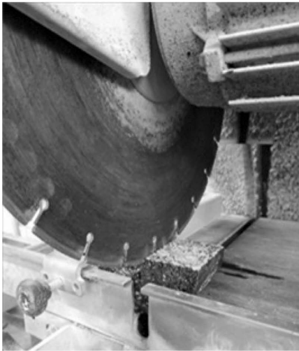
Figura 6. Entalladura de la probeta semicilíndrica
