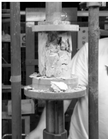
Figura 3. Ensayo a compresión simple.
