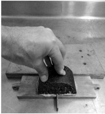
Figura 13. Pegado de probeta sobre soporte
