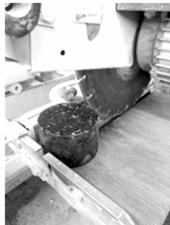
Figura 5. Corte de la probeta por la mitad
