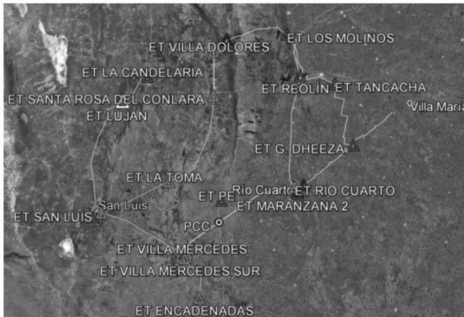
**Figura 2:** Imagen satelital con identificación de las trazas del corredor anillado de 132 kV entre las provincias de Córdoba y San Luis
