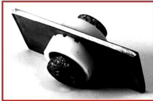
**Figura 1:** Probeta y sistema formador de intersticios empleado en la determinación de la temperatura crítica intersticial (TCI).
