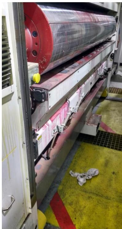
**Figura 6:** Rodillo de la maquinaria teñida por liberación de tinta debido a desperfecto de un PLC luego de una reconexión eléctrica.
