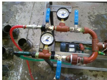
**Figura 2:** Manómetros del dispositivo
