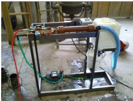
**Figura 1:** Dispositivo formador de espuma
