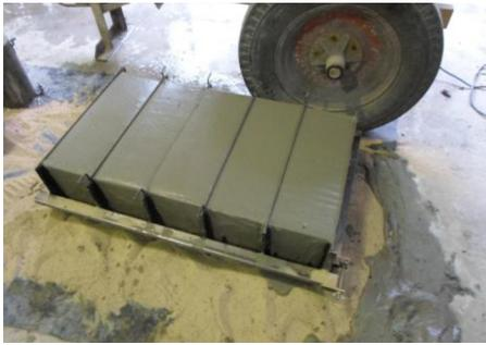
**Figura 7:** Moldes llenos en una tirada
