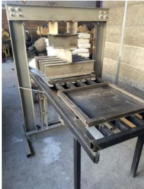
Figura 2. Equipo utilizado para la producción de placas de cielorraso
