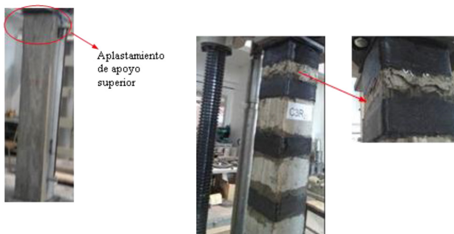
Figura 6. Modos de falla: a) de columna de referencia; b) columna reforzada con PRFC
