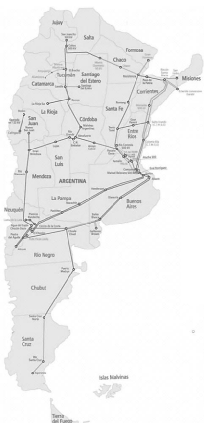
Figura 3. Sistema de transporte en alta tensión de Argentina operado por Transener (Fuente: Transener, 2021).
