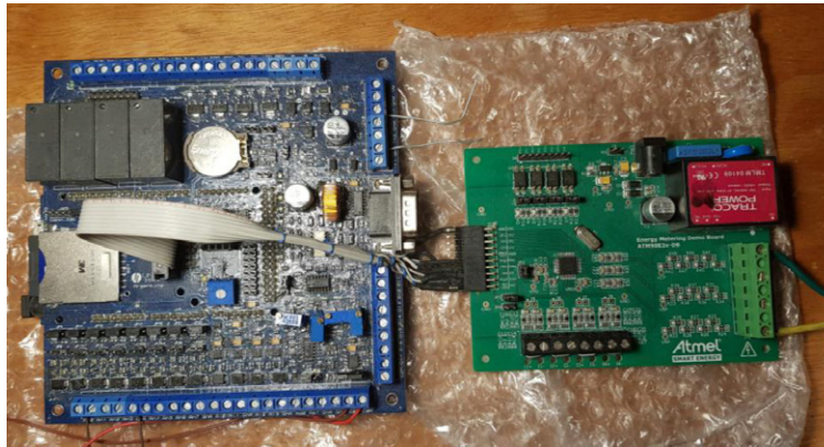
Figura 5. Conjunto de nodo remoto (izquierda) con placa medidora de energía eléctrica (derecha)
