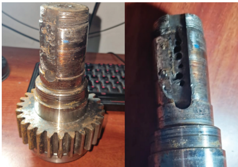
Figura 1: imagen del conjunto (derecha) imagen del modo de falla (Izquierda)
